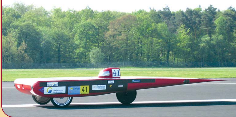
Bild 1. Das Solarfahrzeug HansGo ist an der Oberseite komplett mit Solarzellen bestückt. Diese Zellen sind der ausschließliche Energielieferant für den Wagen.
